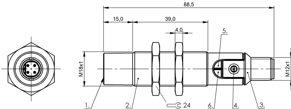
1) Superficie activa, 2) Carcasa, 3) Tapa, 4) Potenciómetro, 5) LED tensión de servicio, 6) LED de indicación de función
